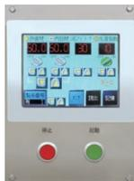
生産個数、製品の大きさ、素材の比率など生産条件の設定は、5.7型のタッチパネルによって簡単に行えます。製品記憶置(P.M.U.)により生産条件の再現もワンタッチです。
