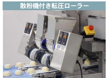
コンベヤー上に二次成形オプション 2列を倍の4列に、4列を倍の8列を搭載し、段階を追って美しく成形にします。倍列効果により、後工程の自由度が高まります。
