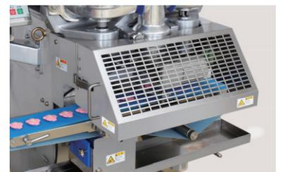
「重合ノズルワイヤーカッタースライサー」を取り付けたCN050。(専用の安全カバーが付属されています)
