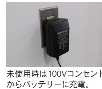
未使用時は100Vコンセントからバッテリーに充電。
