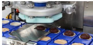
丸や楕円形の製品、固形物が入ったフィリング。比較的大きなサイズの製品に適しています。
