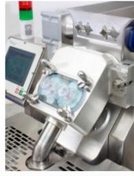
フィリングの送り機構は、吐出時の計量精度が高いサイクロイドタイプの整流器を採用。また、吐出口までの移送経路を短くするなど、素材に優しい構造です。
