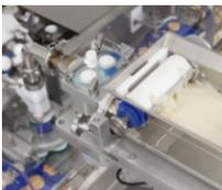
本装置をマルチサンドシステムに接続することで、もう一種類のフィリングを充填できますので、付加価値の高い製品づくりにお役立ていただけます。
