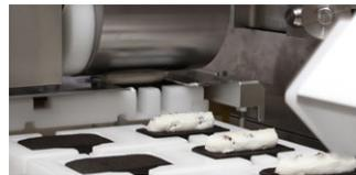
バタークリームのような比重の軽いフィリングや、ペースト状の保形性が弱いフィリングに適しています。レーズン入りのクリームでも安定して定量吐出できます。
