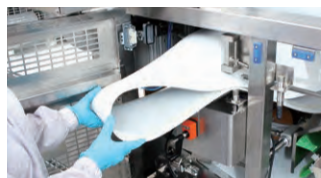
コンベヤーのベルト着脱
