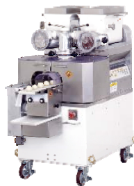
『CN120』（1993年） 機械サイズが小さくなり、部品の着脱がしやすくなるなど操作性が向上し、年齢・性別にかかわらずさまざまな人が使用可能となった。
