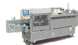
『FEライン』（2017年） 手包み作業の熟練者でなくても、あんぱんやカレーパンなどの包み工程自動化を可能とするともに生地を傷めず高品質化を実現した。
