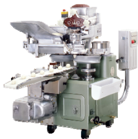
『N208型』（1986年） 手粉などを使わずに成形ができる「非粘着インクスター」を開発し、「包着盤」と使い分けることで和菓子・洋菓子・パン・調理食品などさまざまな食品の自動生産が可能となった。
