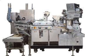
『MMライン』（1974年） 生地を薄く延転し折りたたむことを自動化し、高級嗜好品であったパイ・デニッシュ類の大衆化を実現した。
