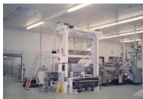
『F.A.R.-IIシステム』（CWCライン）（1988年） アメリカノースカロライナ州の実験工場に導入されたコンピュータ制御型完全無人化システム。「発注」「生産」「品質」に至る製パン工場のさまざまな業務をシステムで管理できるようになった。
