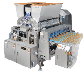
『マルチコンフェクショナー』（2010年） 新開発の吐出機構とインクスターにより高い生産性を実現し、国連食料支援機関(WFP)の指定食品生産においても使用されている。
