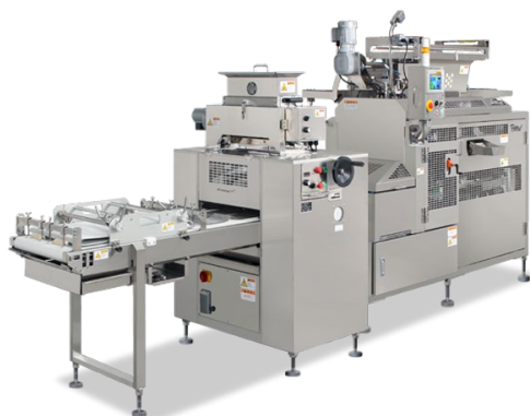
図表2-(3)-7. 小型製パンライン「ストレスフリーVMシステム」
